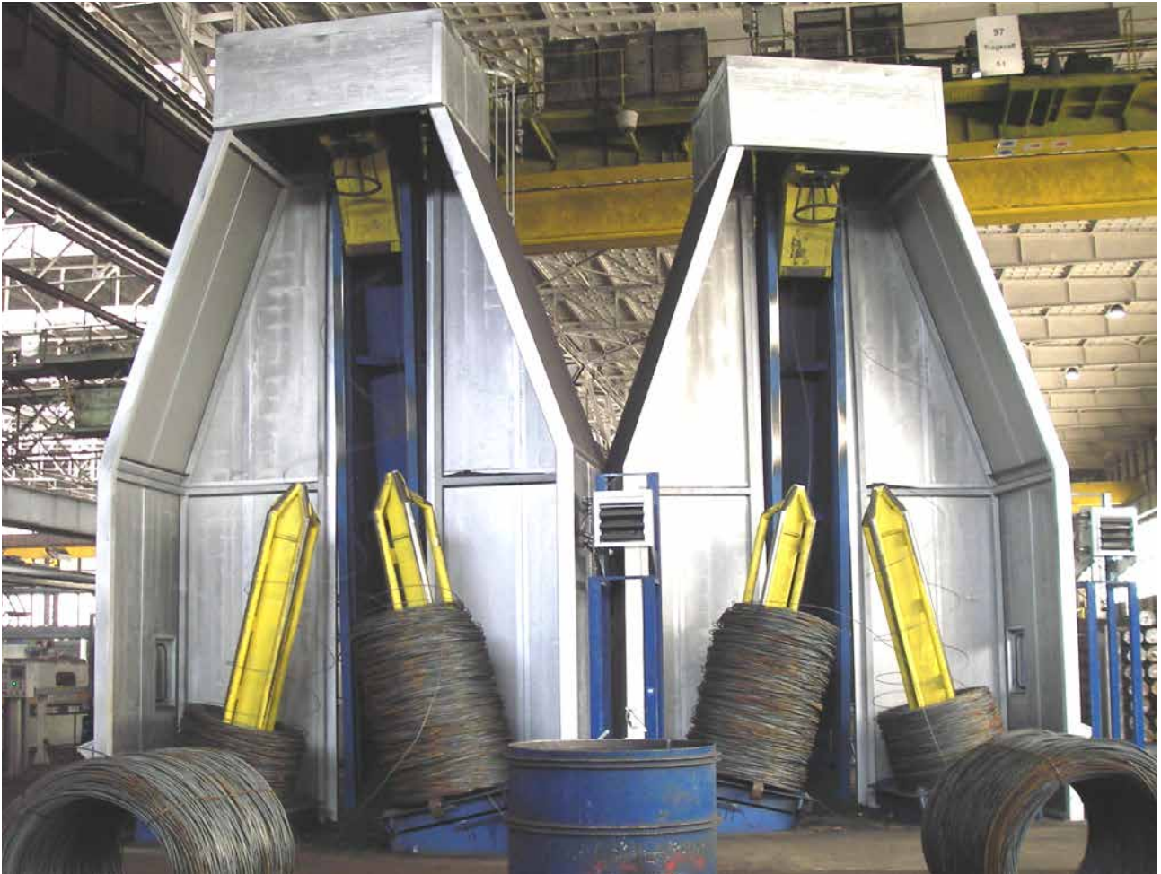
Walzdrahtablauf an den TEUREMA-Reckanlagen mit realisierten Schallschutzmaßnahmen
