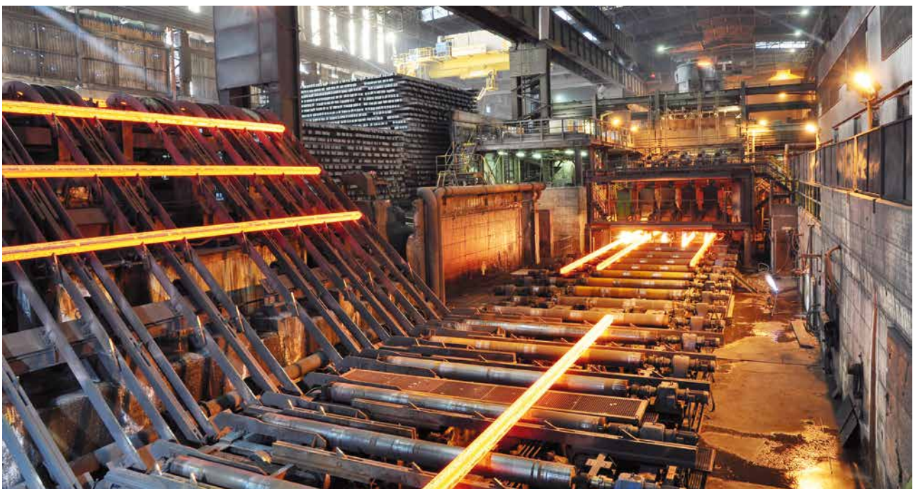
Die Stranggussanlage im Betrieb: Erzeugung von Knüppeln
