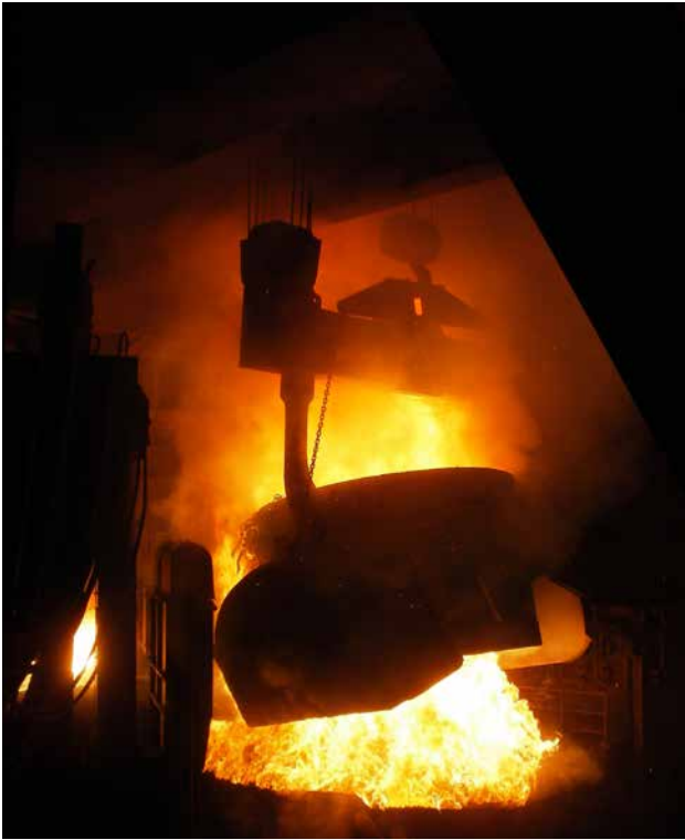
E-Ofen im Betrieb, dargestellt sind das Chargieren (links) sowie das Einschmelzen (rechts)
