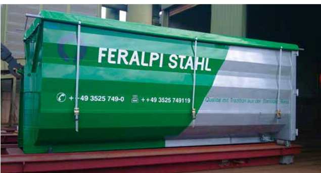
Lagerbereiche Kondirator, geschlossenes Containersystem für Schredderrückstände (SRS)
