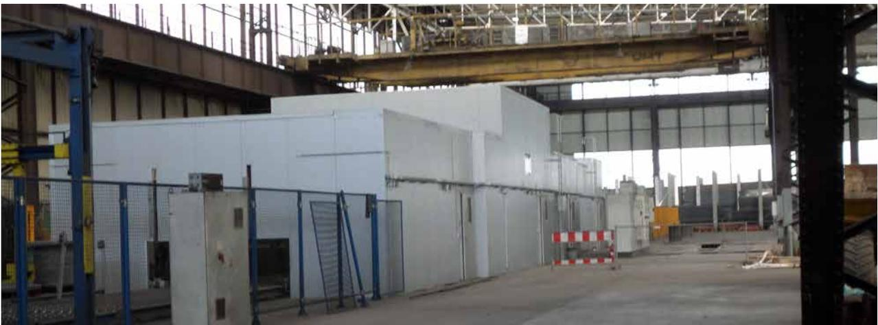
*Kapselung Mattenschweißmaschine, Mattenhalle EDF (seit 2015)*
