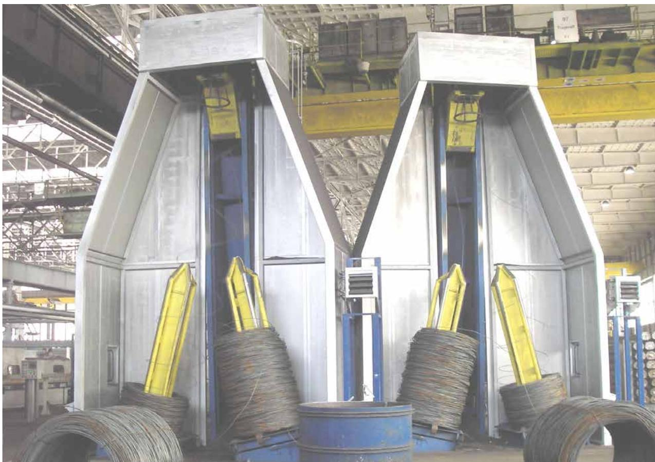
Walzdrahtablauf an den TEUREMA-Reckanlagen mit realisierten Schallschutzmaßnahmen
