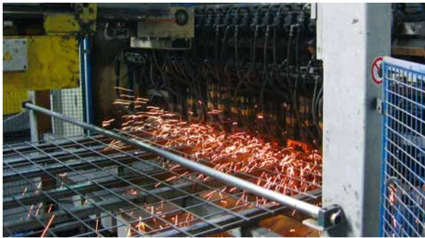
Automatische Mattenschweißmaschine im Betrieb
