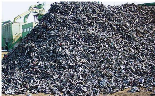
Chargierfähige Schrotte zum Einsatz im E-Ofen der ESF, hier: Alt- und Neuschrotte, Schredderschrott (von links oben nach rechts unten)
