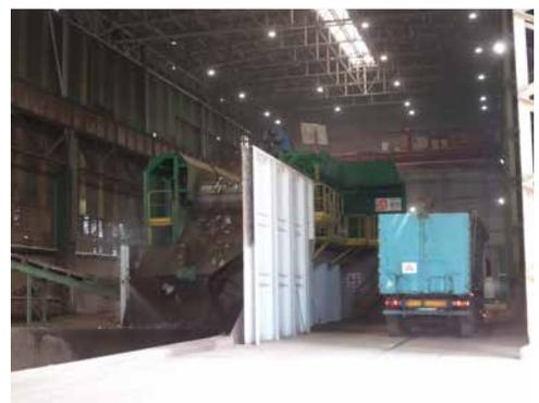
Lagerbereiche Kondirator, geschlossenes Containersystem für Schredderrückstände (SRS)
