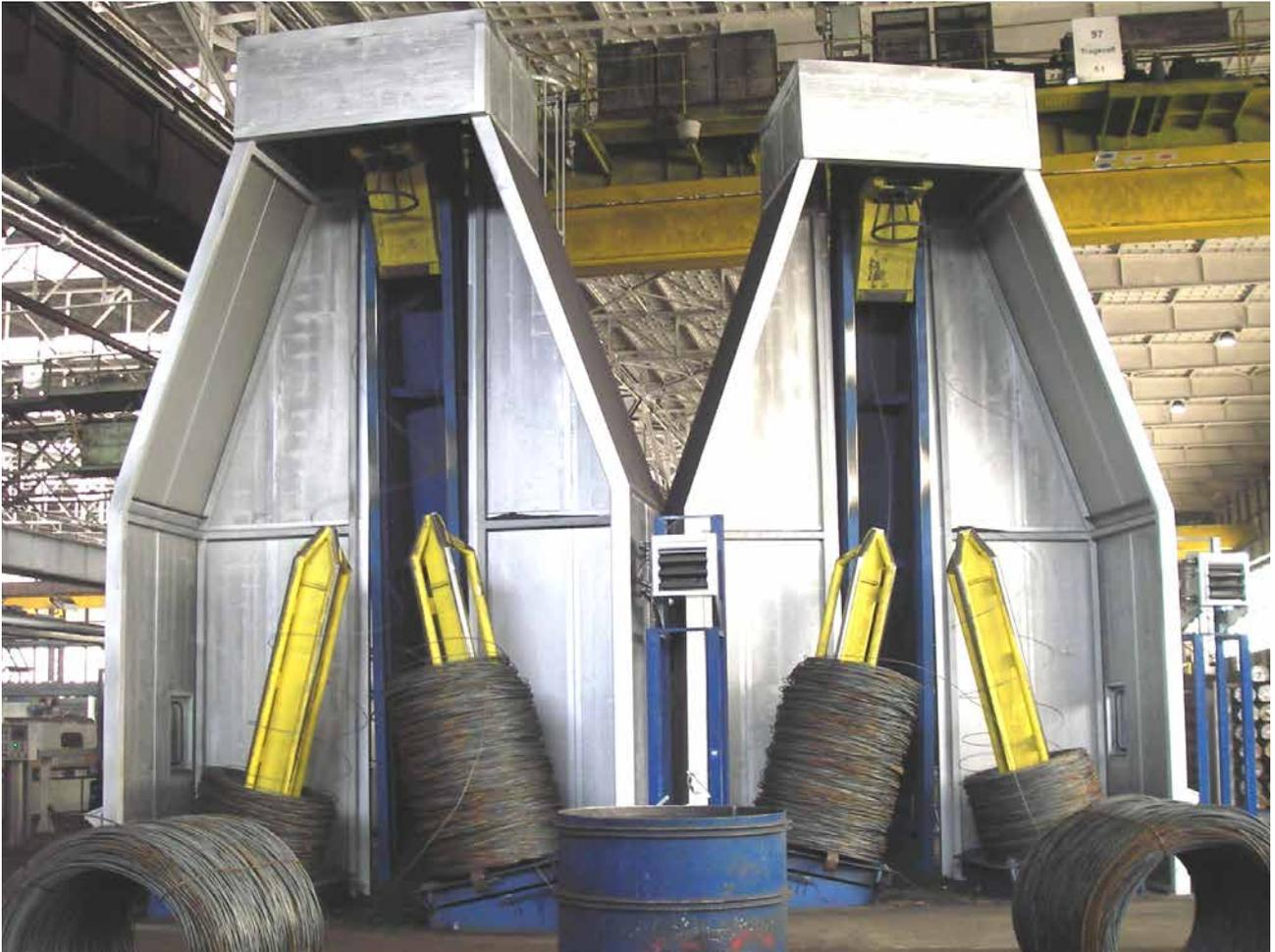
Walzdrahtablauf an den TEUREMA-Reckanlagen mit realisierten Schallschutzmaßnahmen
