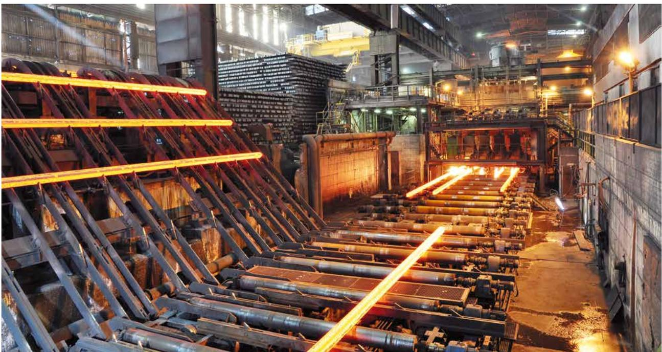
Die Stranggussanlage im Betrieb: Erzeugung von Knüppeln
